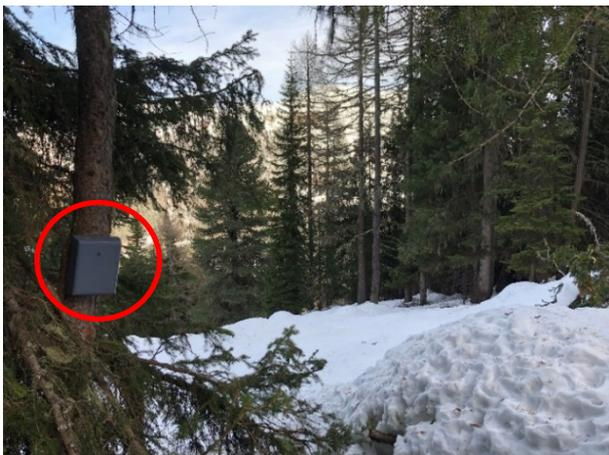
Abbildung 3 Automatisches Zählgerät (roter Kreis) auf ca. 80 cm Höhe entlang der Ski- und Snowboardtouren Route Tschierv - Piz Dora (ZHAW, 2020).
